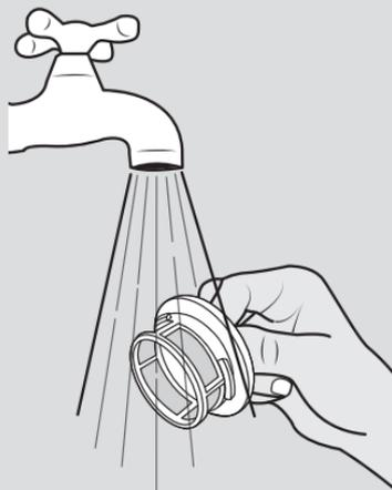
Après le nettoyage remettre le bouchon- filtre en position
